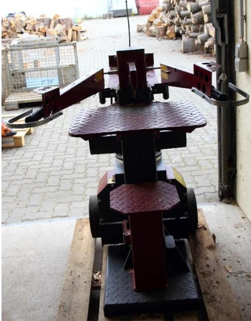
Der **Holzspalter** wird ebenfalls mit elektrischem Strom angetrieben.
