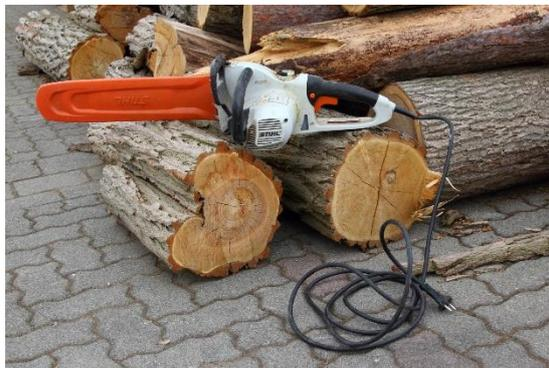
Mit der **elektrischen Kettensäge** kann man nur dort arbeiten, wo elektrischer Strom ist. Wir setzen sie ein, wenn wir auf dem Gelände der Werkstatt arbeiten. Die elektrische Kettensäge hat den Vorteil, dass sie nicht so laut ist und beim Arbeiten auch keine Abgase entstehen.
