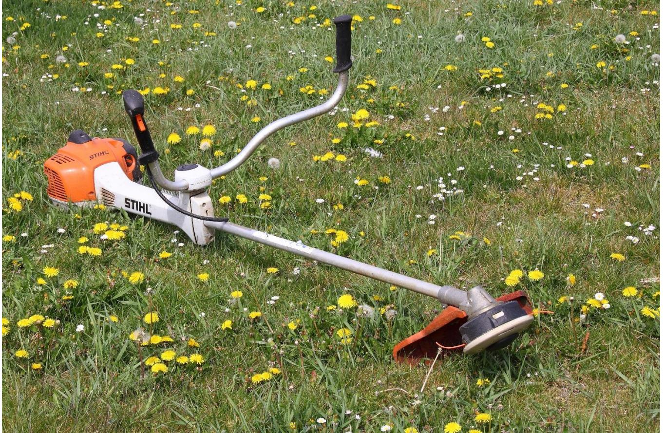
Wie die vorher genannten Maschinen, wird auch der Freischneider mit einem Benzinmotor angetrieben.
