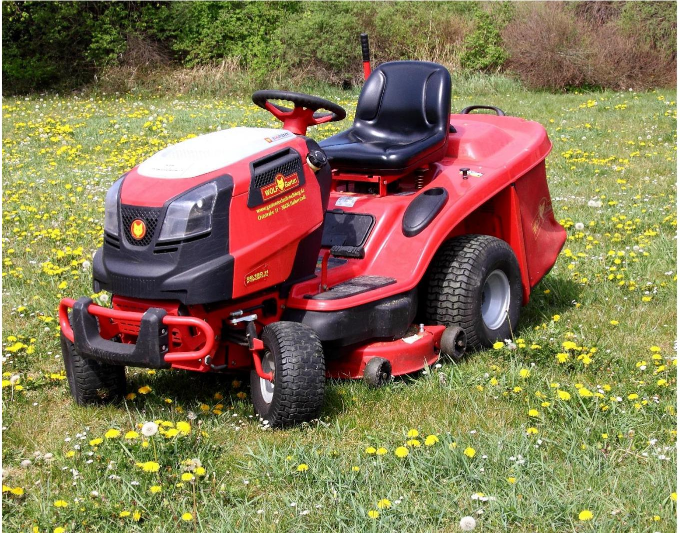
Ein Mitarbeiter sitzt auf dem Traktor und mäht damit große Rasenflächen. Der Rasentraktor wird ebenfalls mit einem Benzinmotor angetrieben und fängt den Rasenschnitt auf.
