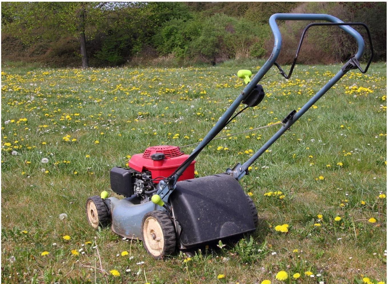
Unsere Rasenmäher werden mit einem Benzinmotor betrieben, um nicht von einer Stromquelle abhängig zu sein. Der Rasenmäher wird dabei von einem Mitarbeiter geschoben. Mit dem Rasenmäher kann man den Rasen auf eine bestimmte Höhe schneiden. Der Rasenschnitt wird dabei aufgefangen und anschließend entsorgt.
