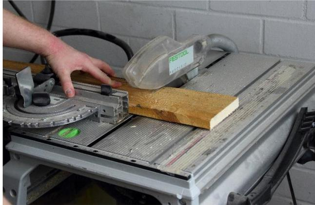
Mit der **Tischkreissäge** werden in der Tischlerei der Diakonie Werkstätten Halberstadt die Nadelholzreste (Bretter, Leisten, Besäumabschnitte) zugeschnitten. An der abgebildeten Tischkreissäge dürfen nur die Mitarbeiter\*innen tätig sein, die über die entsprechenden Unterweisungen verfügen. Beim Arbeiten an der Maschine, die sehr laut ist, muss zum Schutz des Gehörs ein Gehörschutz getragen werden.
