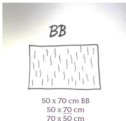
Bei einem Papier, das **Breitbahn** oder **BB** gekennzeichnet ist, ist die Laufrichtung parallel zur kurzen Kante.
