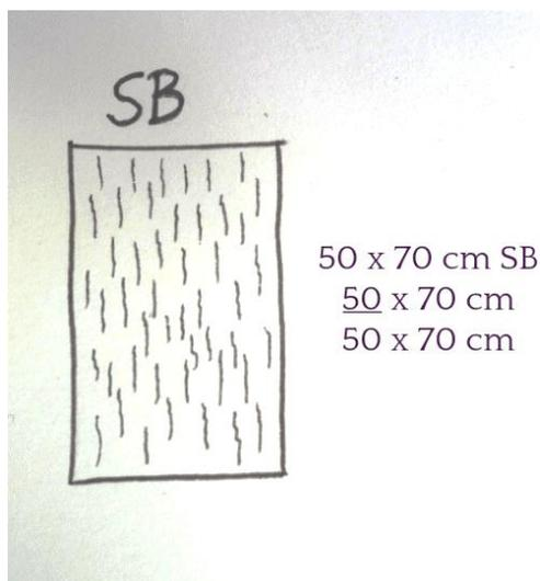
Bei Papier, das **Schmalbahn** oder **SB** gekennzeichnet ist, ist die Laufrichtung parallel zur langen Kante.
